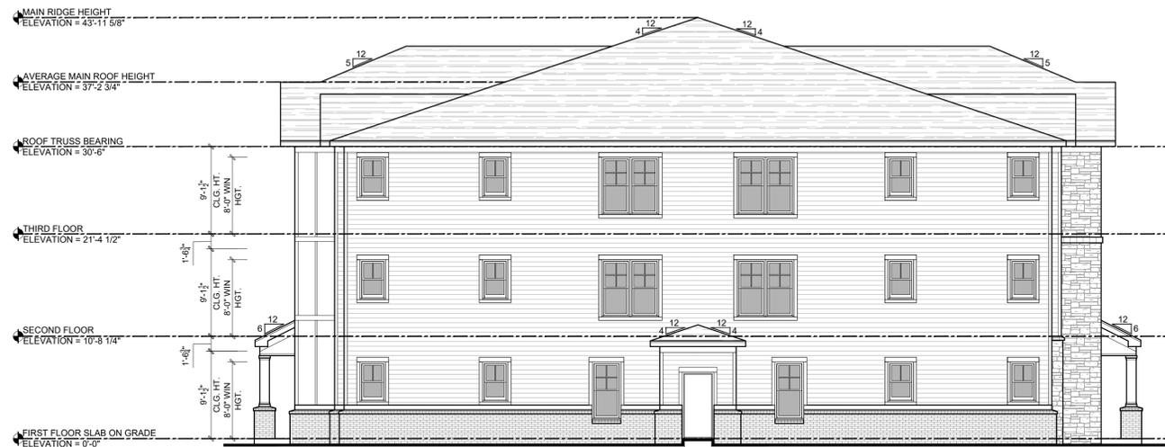
**2 BUILDING TYPE 2 - SIDE ELEVATION (LEFT SHOWN)**
